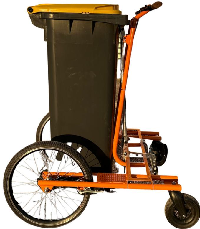
Le chariot bio-déchets & conteneurs lourds permet de déplacer un conteneur en évitant de l'incliner. Il soulève une charge importante, + de 120 kg, l'effort de soulèvement du bac s'effectue avec un mécanisme actionné par la jambe. Le roulage se fait naturellement en poussé frontal avec un rachis équilibré. Les 4 roues optimisent le déplacement.
